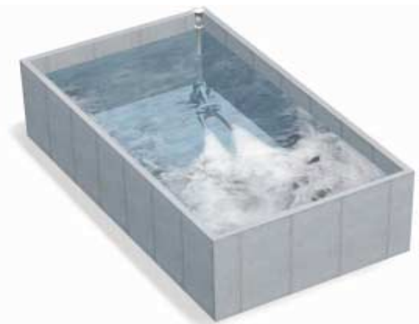
Oxidatie voor stankbeheersing of verhoging van opgelost zuurstofgehalte.
