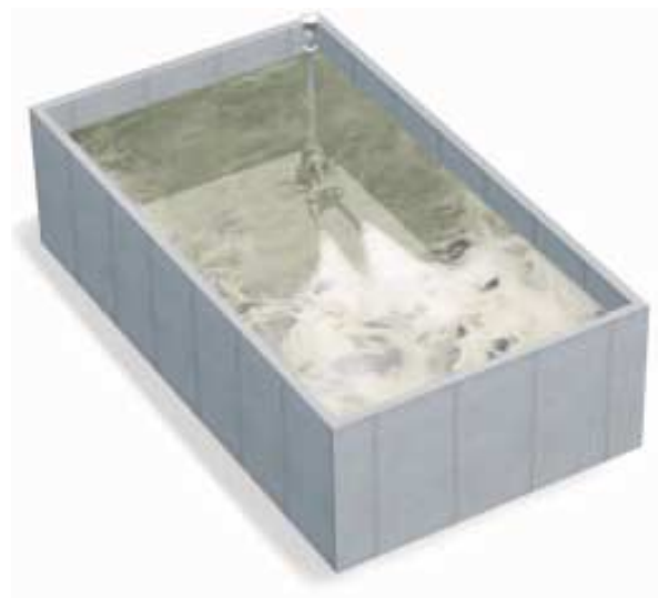
Actief slib-installaties Boven: een carousel Onder: rechthoekige beluchtingstank
