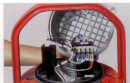
Vrijwel alle Grindex pompen hebben een ingebouwde startschakelaar en motorbeveiliging voor een betrouwbare werking.
